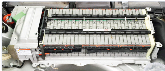
Figure 2. Batterie de l'ancienne Prius II de l'auteur. Vous pouvez voir 28 paquets de 6 cellules chacun soit 201,6 V de tension nominale.
