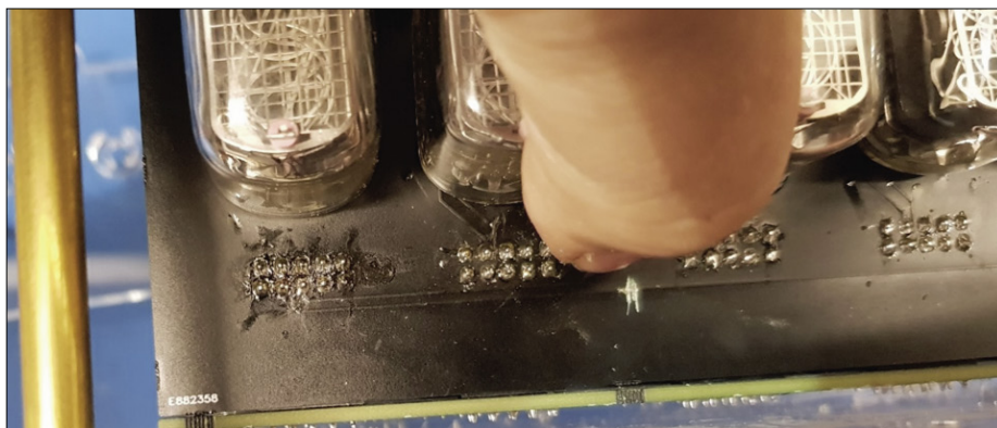
Figure 2. Élimination d'un tronçon de piste de PCB pour déconnecter un néon de son pilote (la modification ne s'applique qu'aux PCB existants !)
