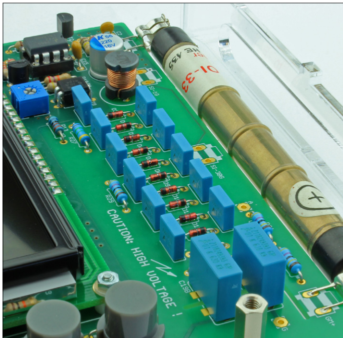
Figure 5. Un tube Geiger-Muller ne fonctionne que sous haute tension.
