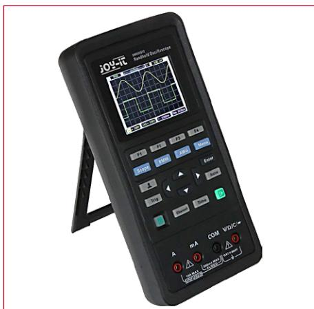
Cet appareil de poing, pratique et polyvalent, combine les fonctions d'un oscilloscope à 2 voies (70 MHz), d'un générateur de fonctions (250 Méch/s) et d'un multimètre (4000 p.). La résolution de son afficheur TFT-LCD couleur de 7,1 cm rétroéclairé est de 320x240 pixels. Il tient toute une journée sur ses batteries (li-ion) rechargeables (USB-C).
