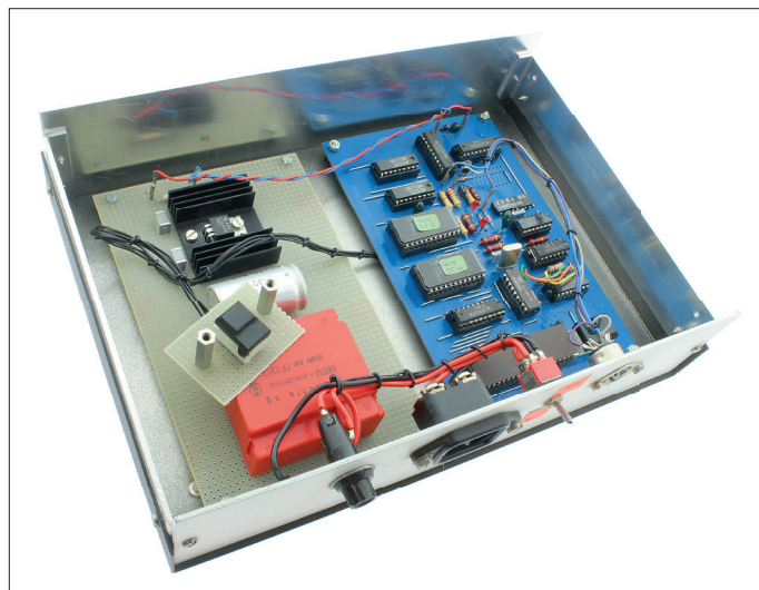
Figure 1. Le boîtier de l' intelekt sans son couvercle. Le poussoir est de type Digitast qui offrait un subtil retour tactile. On le voit ici soudé sur un petit morceau de carte à pastilles, sur deux entretoises et connecté à la carte par des fils.
