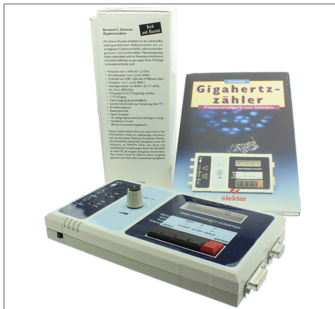
Figure 4. L'ensemble du projet vendu par Elektor en Allemagne comprenait un livre et un kit complet. Cette offre groupée n'est apparue qu'en 1995, bien après la publication du fréquencemètre dans le magazine Elektor.
