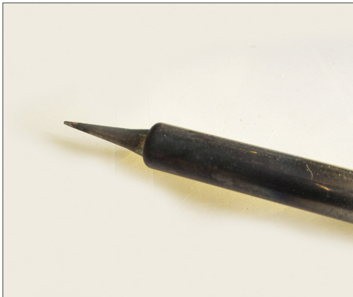
Figure 3. La station est fournie avec une panne fine (1,2 mm) en forme de crayon.
