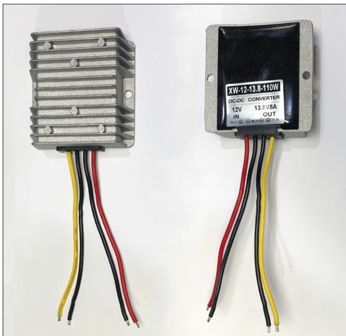
Figure 7. Convertisseur CC/CC : 9 à 14 V | 13,8 V, étanche, encapsulé dans un robuste boîtier alu.
