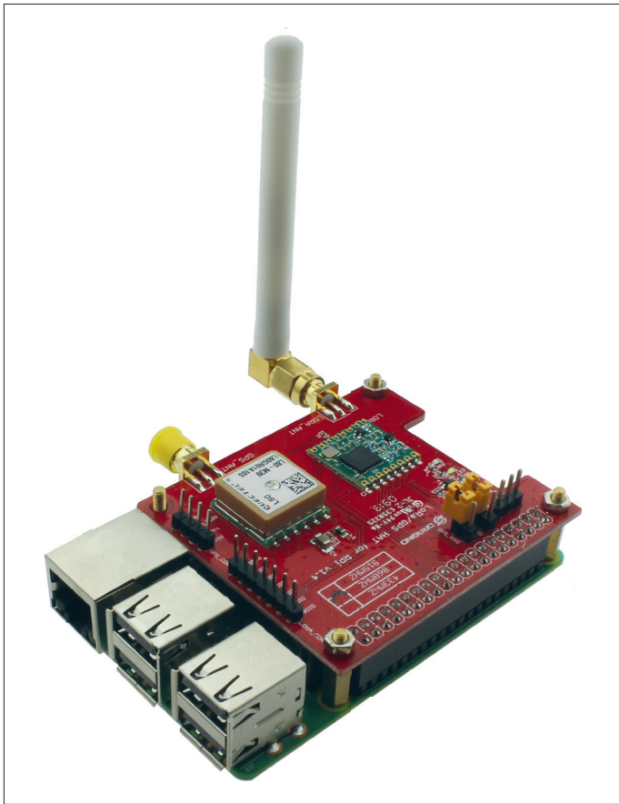
Figure 15 : Un Raspberry Pi avec Dragino-LoRa-HAT comme passerelle.
