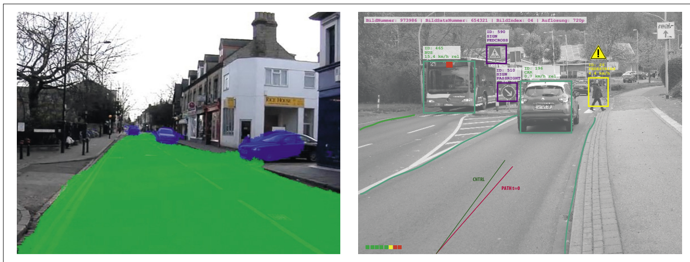
Figure 5. Deux types de classification courants : segmentation sémantique à gauche et reconnaissance d'objets à droite (à gauche avec l'autorisation de MathWorks, à droite avec l'aide de Rolf Gerstendorf).
