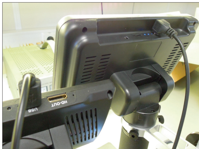
Figure 3. Grâce à la prise USB soudée, le câble s'utilisera moins vite.
