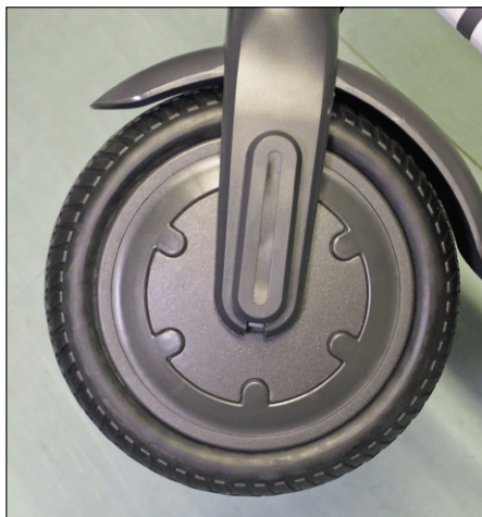
Figure 7. Roue avant avec moteur-moyeu et pneus en caoutchouc plein.
