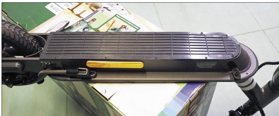
Figure 9. Le dessous de caisse est en plastique et peut être dévissé.
