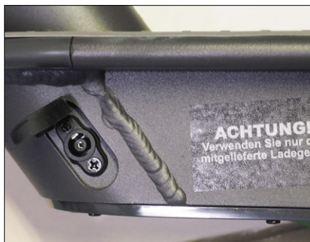
Figure 13. Prise de charge sur le côté gauche de la trottinette.
