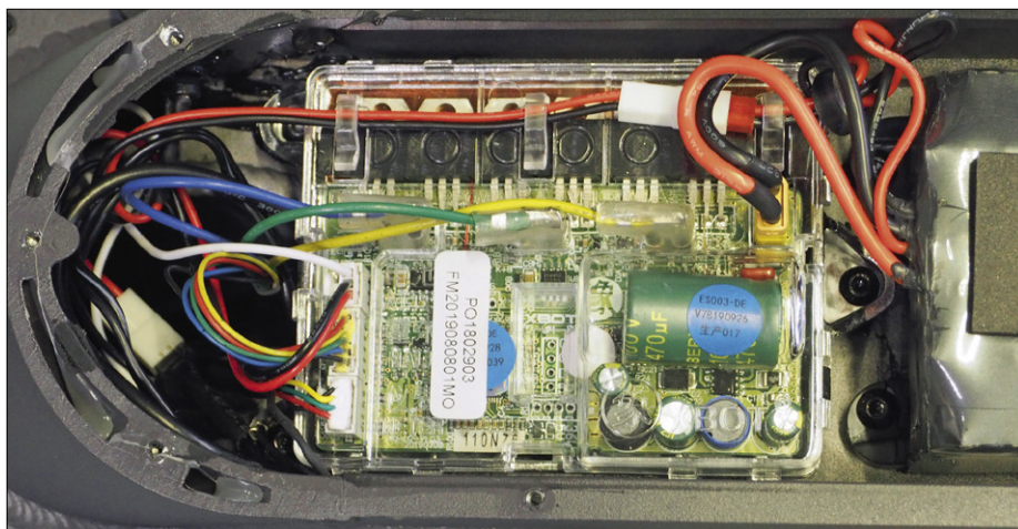
Figure 12. Les six MOSFETs de l'électronique encapsulée.
