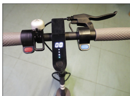
Figure 5. Guidon et tableau de bord allumé : la batterie est déchargée.
