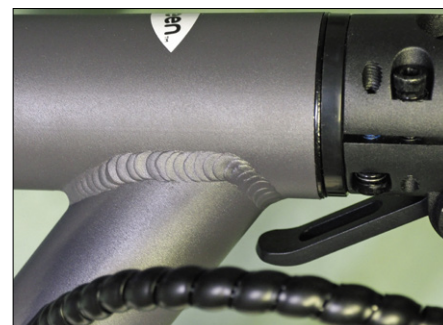
Figure 6. Soudure solide et mécanisme de pliage.
