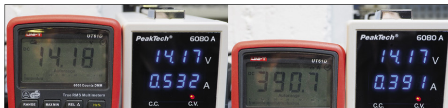
Figure 3. Comparaison de l'affichage du multimètre et de l'affichage de l'alimentation de laboratoire (à gauche : tension, à droite : courant).
