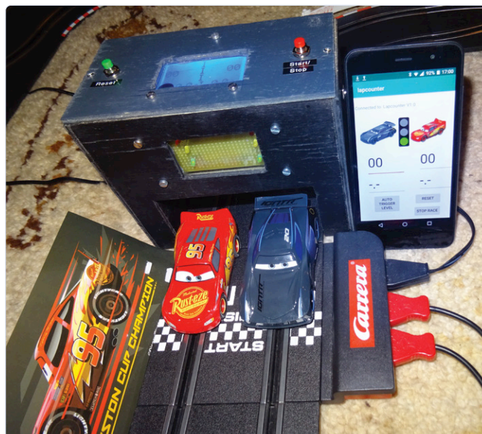
Figure 1. Le compteur de tours s'adapte parfaitement à une piste de course à deux voies.
