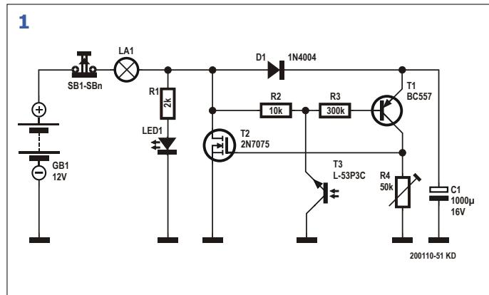
Cet état est stable tant que la tension aux bornes de R4 est suffisante pour que T2 continue de conduire. Une fois que C1 s'est suffisamment déchargé pour que T2 s'éteigne, l'état initial est rétabli ; après un court instant, C1 est rechargeé à travers D1 et le circuit est réarmé.
