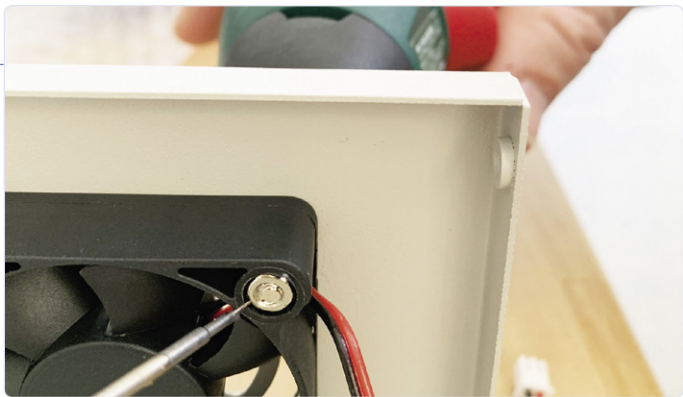
Figure 5. Un tournevis fin permet de bloquer les écrous lors du vissage du ventilateur.
