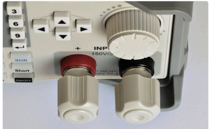
Les grandes bornes à vis sont robustes, mais excluent malheureusement l'utilisation de fiches bananes.
