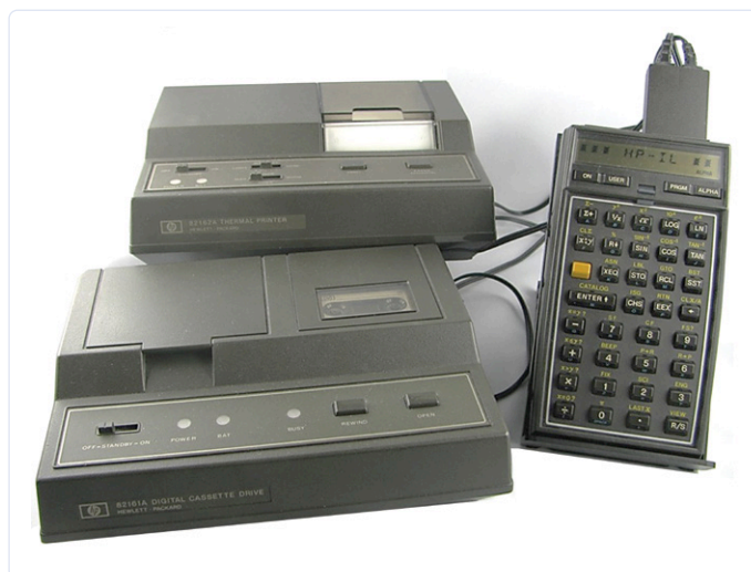
Figure 2. Une installation HP-IL composée d'une HP-41C, d'un lecteur de cassettes numériques et d'une imprimante
