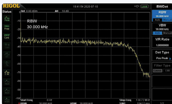
Figure 14. En mode bruit blanc, le niveau est quasi stable jusqu'à 100 MHz.
