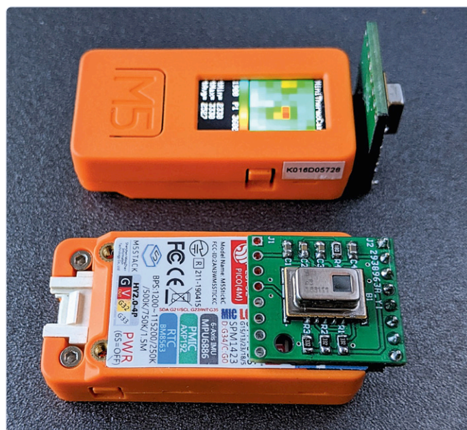
Figure 6. Droit ou coudé : deux manières de connecter le capteur au M5StickC.
