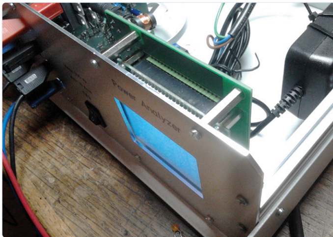
Figure 4a. La carte principale et l'afficheur en façade.
