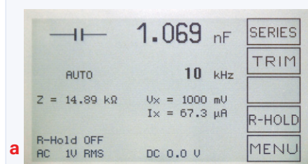
Figure 5a. Mesure d'un condensateur de faible capacité à fréquence élevée.
