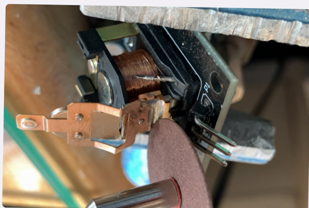
Figure 3c. Retirez le contact de l'interrupteur et coupez le noyau.
