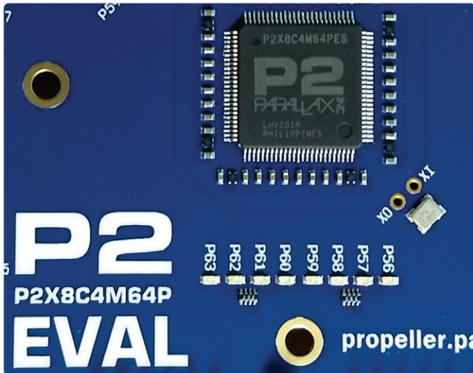
Figure 4. Détail des LED connectées aux broches 56 à 63 du microcontrôleur.
