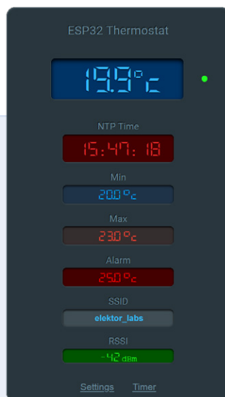
Figure 5. La page principale affiche la température mesurée ainsi que les seuils de commutation et d'alarme.
