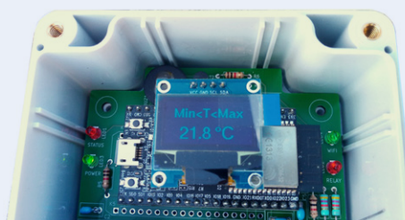
Figure 3. Le thermostat construit par le labo d'Elektor utilise un module DevKitC ESP32 avec un module d'affichage OLED séparé.
