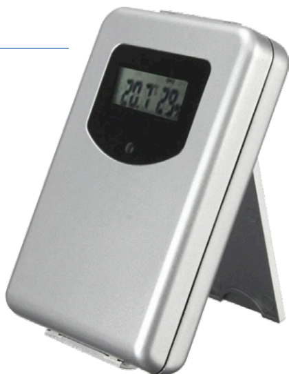
Figure 1. Pour environ 5 €, vous pouvez trouver un capteur de température et d'humidité chez DANIU qui transmet ses valeurs sur 433,92 MHz et les affiche en clair sur un écran.
