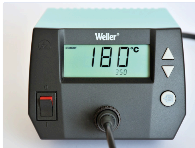
Figure 5. Quand le fer reste inutilisé pendant un certain temps, la station réduit automatiquement la température à 180 °C.
