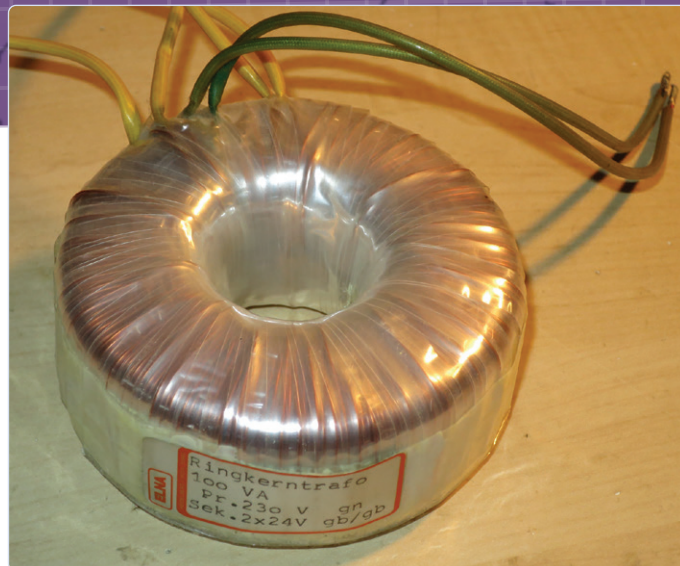
Figure 4. Transformateur torique de 100 W utilisé pour les expériences.
