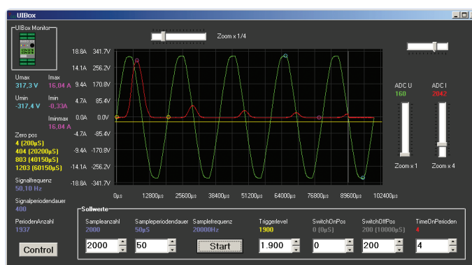
Figure 3. Le logiciel sur PC en action affiche la tension du réseau (vert) et le courant (rouge). Ici, la tension a été appliquée à la charge pendant un passage par zéro (ligne grise verticale de gauche) et retirée neuf passages par zéro plus tard (ligne grise verticale de droite).
