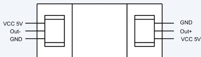
Figure 3. Schéma de connexion des capteurs à effet Hall.
