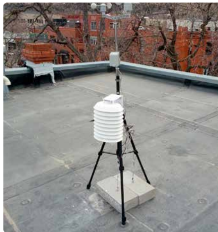
Figure 2. Station météorologique sur trépied lesté.
