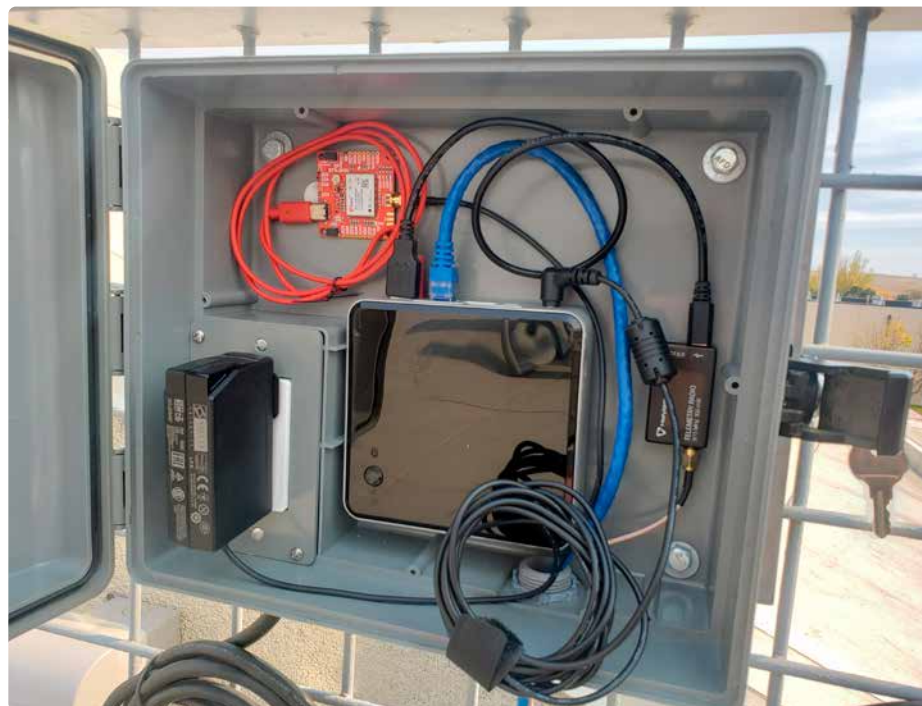
Figure 19. NUC (mini PC) connecté à un ZED-F9P et à une radio 915 MHz par USB.
