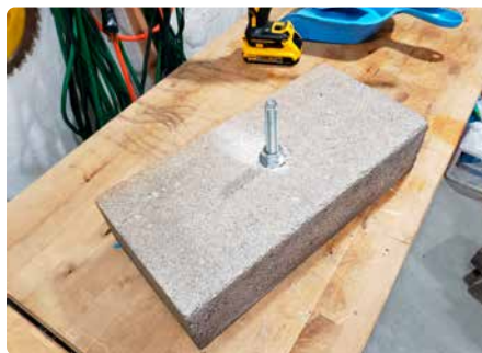
Figure 5. Ancrage fixé par un boulon - et ce parpaing-là est intact !
