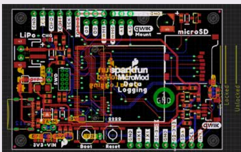
Figure 6 : Empreinte Eagle PCB prête et symbole d'une carte porteuse.
