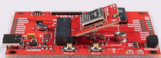
Figure 3 : Carte processeur MicroMod insérée à un angle d'environ 25 degrés.
