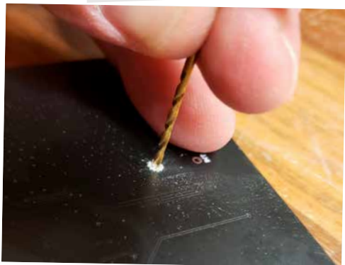
Figure 9 : Fin de perçage à la main.
