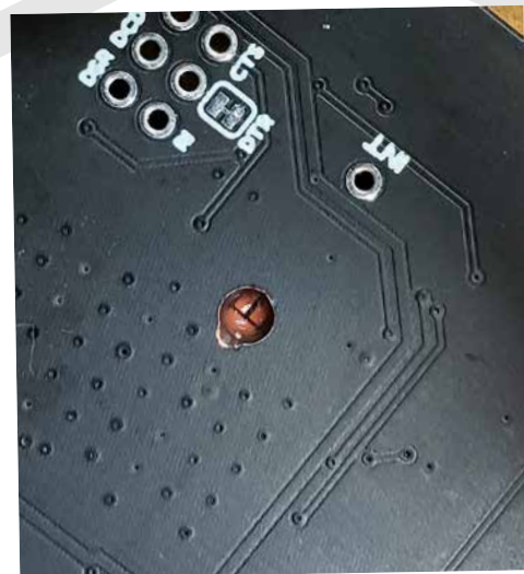
Figure 13 : L'alcool rend le FR4 transparent.
