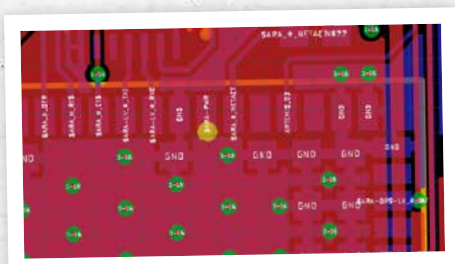
Figure 5 : Position de la pastille vue de l'arrière (ou du dessous) de la carte.
