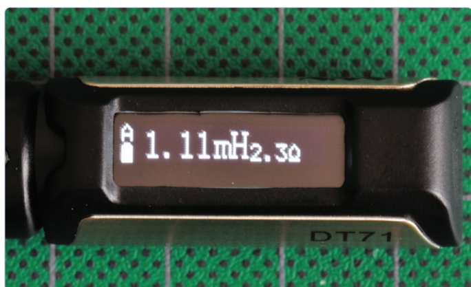
Figure 4. L'écran OLED n'affiche généralement que la valeur, mais dans le réglage Auto, une deuxième valeur peut apparaître, comme dans le cas de cette inductance.
