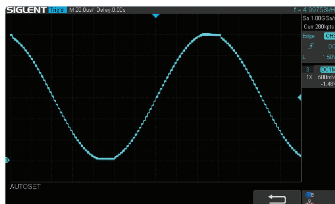
Figure 5. Signal de sortie du générateur de signaux. Les sommets de la sinusoïde (ici 5 kHz) sont un peu aplatis et les pas de synthèse numérique sont clairement visibles.
