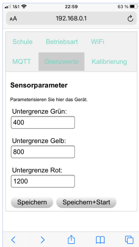
Figure 4. Une des pages web de configuration. Les utilisateurs peuvent saisir les seuils pour le feu tricolore. Une version anglaise des pages web est prévue.
