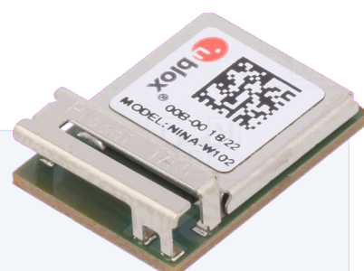
Figure 1. Le module MCU multi-radio autonome u-blox NINA-W102 a un ESP32 d'Espressif sous le capot (source : u-blox).
