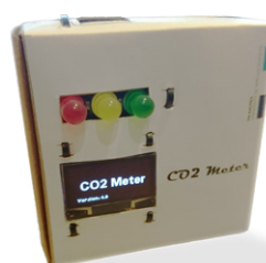
Kit de mesure du CO 2 pour salle de classe Montage à base d' ESP8266
