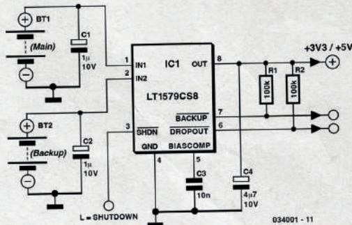
surer le maintien à la valeur requise de la tension de sortie, la sortie à drain ouvert DROPOUT le signale par le biais d'un signal de niveau logique bas.
