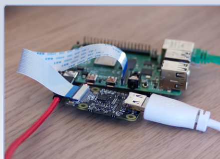
Figure 18. Installation terminée avec le pont HDMI-CSI.
