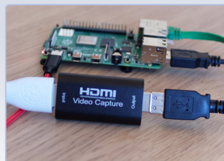
Figure 19. Installation terminée avec la clé d'acquisition HDMI-USB.
