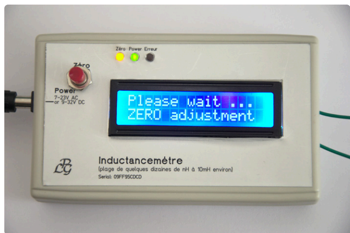
Figure 4. Pour assurer une bonne précision, chaque mesure est effectuée en deux étapes. On voit ici l'étape 1, la séquence d'étalonnage du zéro.
