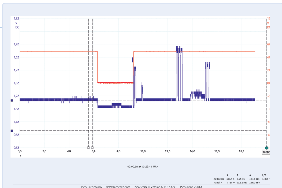
Figure 1. La bande 433 MHz est très occupée. Les signaux de différents modules d'émission sont représentés ici. La séquence d'impulsions centrale est celle que nous voulons.
