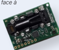
Figure 3c. Le module capteur de CO 2 (à gauche) et divers affichages.
