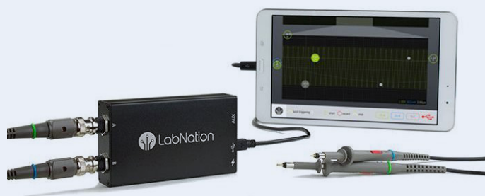
Figure 3. Un oscilloscope sans écran permet de gagner de la place sur la paillasse. Mais est-ce bien le cas ? Il faut un ordinateur ou une tablette pour visualiser les signaux.
