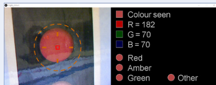
Figure 7. Réponse de tlight_detect.pde avant d'apprendre des couleurs.
