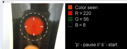
Figure 6. computer_vision.pde crée les valeurs RVB « vues » par la caméra pour chaque couleur du feu de signalisation.
