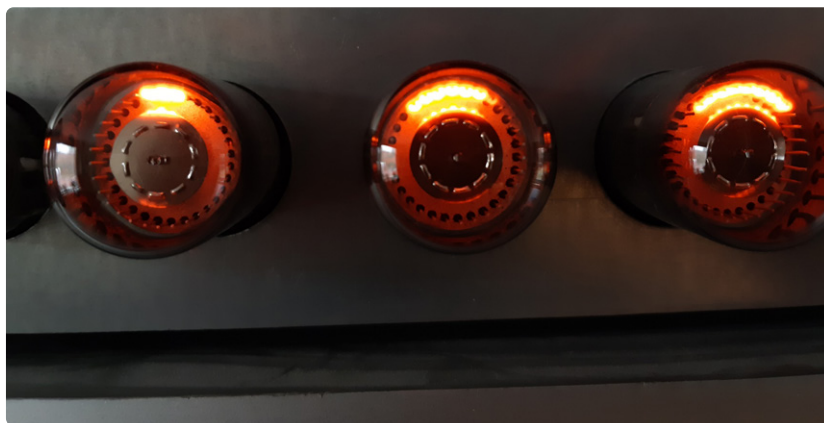
Figure 7. Zoom sur trois afficheurs dekatron.
