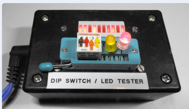
Figure 3. Un testeur de commutateurs DIP et de LED bricolé qui teste ici un commutateur DIP à 4 voies et une paire de LED.
