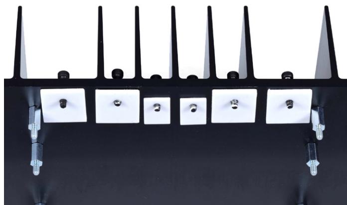
Figure 21. Les pastilles en céramique sont recouvertes d'un côté d'une fine couche de pâte thermique et placées sur les vis partiellement insérées. Le dissipateur thermique doit être positionné verticalement.
