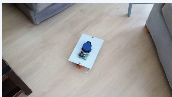
Figure 8. Le chariot évite les obstacles grâce à un simple algorithme de recherche d'un écart minimal.
