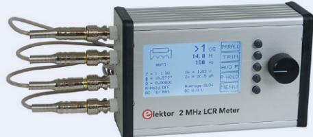
Le LCR-mètre 50 Hz - 2 MHz est un appareil de haute précision pour tester et mesurer les composants passifs. Il peut rivaliser avec les appareils du commerce et même les battre ! [8]
