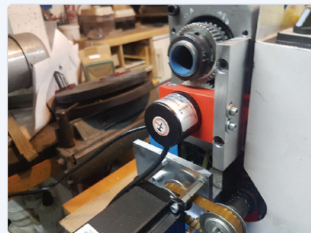
Figure 5. Le codeur pour la synchronisation est monté à l'aide d'un adaptateur...
