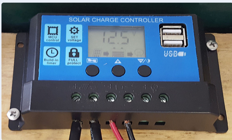
Figure 5. Les régulateurs de charge similaires à celui-ci n'ont certainement pas la fonctionnalité MPPT (même s'ils portent un autocollant MPPT !). (Source : Ministère de l'Énergie des États-Unis)
