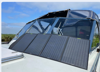
Figure 9. De puissance nominale 120 Wc, le panneau solaire pliant choisi par Martin et Detlev peut être rangé sous le pont en navigation. (Source : Martin Jepkens)
